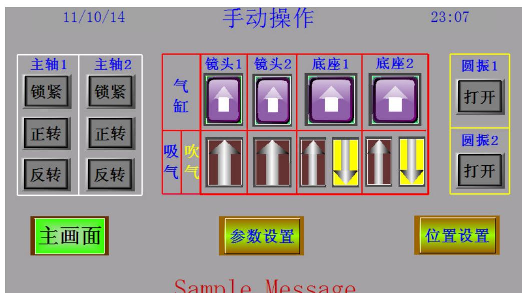
该界面的操作需要在主界面将设备切换为手动状态。可对三爪、吸笔、振动盘作手动控制动作。
