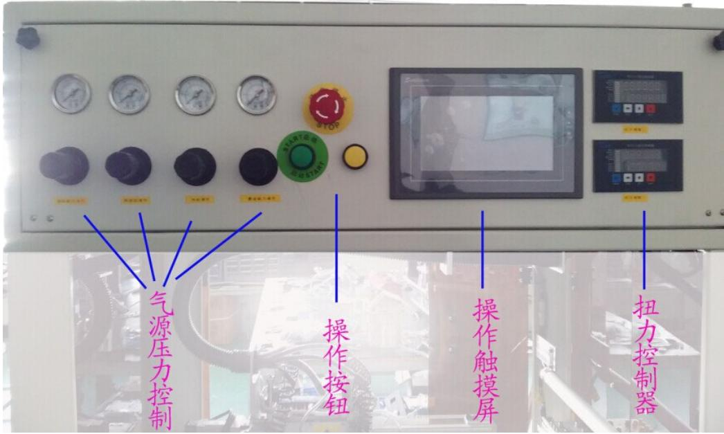
气源压力控制：分别是4个吸头的吸气控制、位移平台底座吸气控制、气缸上下控制和三爪夹持力控制。
