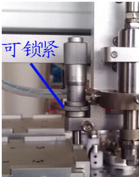
在调整完高度后需将微调锁紧，防止设备移动过程中，微调移动。
